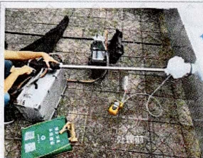
注塑废气排放处理前检测口
